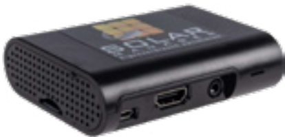
EMS-Gateway ermöglicht die direkte und sichere Kommunikation mit den Geräten vor Ort
