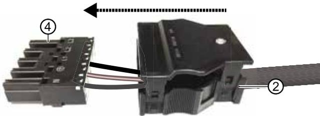
1.7. Korrekt aneinander ausrichten: Oberseite Buchse und Oberseite Zugentlastungsgehäuse sind jeweils durch aufgedrängte Markierungen „TOP“ gekennzeichnet.
