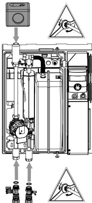
2. Sicherheitsablauf des Sicherheitsventils nach den jeweils geltenden Normen und Richtlinien über einen Trichtersiphon in den Abfluss abführen. Der Anschluss des Sicherheitsablaufes ist zwingend erforderlich!
