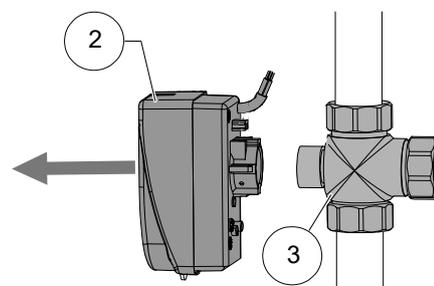
4. Spindel am 3-Wege-Umschaltventil drehen, sodass die abgerundete Seite der Spindel in Richtung Markierung A der Anschlüsse am 3-Wege-Umschaltventil zeigt.
