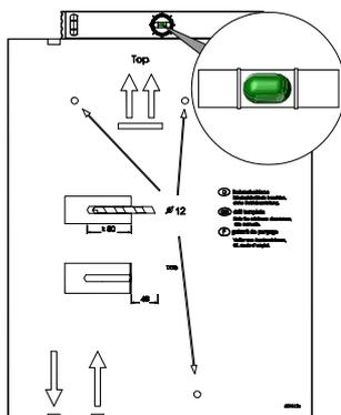
2. Dübel und Stockschrauben in Bohrlöcher einbringen.
