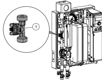
Der Volumenstrommesser / Wärmemengenzähler misst Durchfluss und Temperaturdifferenz im Ladekreis. Die Messbereiche werden im Heizungs- und Wärmepumpenregler eingestellt. Gemessene Werte können am Display des Bedienteils ausgelesen werden.
