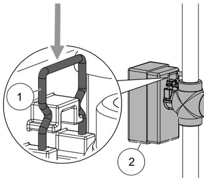
10. Sicherstellen, dass der Bügelstift korrekt eingerastet ist:
