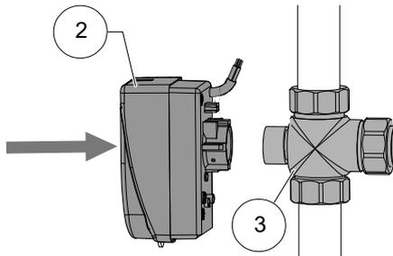
9. Bügelstift (①) auf der Rückseite des Ventilmotors (②) einsetzen.
