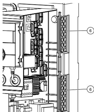
6. Stecker auf Buskabel und Lastkabel von der Wärmepumpe auflegen.
