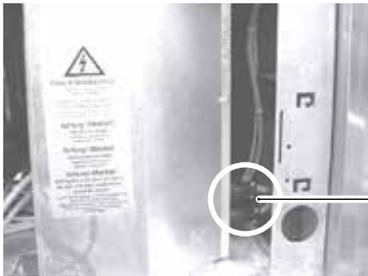
2. Steuer- und Fühlerleitungen im Geräteinnern durch den vorgesehenen Kabelkanal zur Wasseranschlussseite führen.
