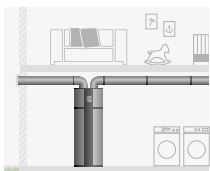
Brauchwarmwasserbereitung im Außenluftbereich
