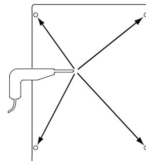
3. Bohrschablone von der Wand lösen, Dübel in die Löcher einschlagen, Schrauben eindrehen (Abstand von Untergrund zu Schraubenkopf etwa 10mm).
